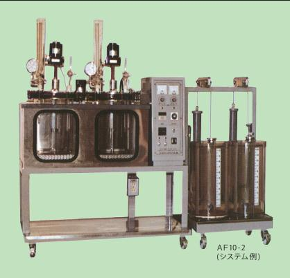
嫌気性消化法は、下水汚泥の処理法として古くから知られ、溶解した有機物だけでなく大きな浮遊物も、酸生成菌により分解されます。生成した低級脂肪酸は、メタン生成菌によりメタンガス、炭酸ガス、アンモニア等のガス類と少量の消化スラッジになります。
